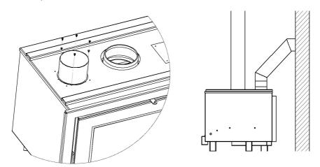
Dentro de cada aparato se incluyen dos conectores para conectar el cassette mediante tubos, y asi enviar aire caliente a otra habitación. Estos conectores se instalan quitando las dos tapas que se pueden ver en la parte superior del cassette (unidas por 4 tornillos), y colocar ahí los dos conectores mediante 6 tornillos.
