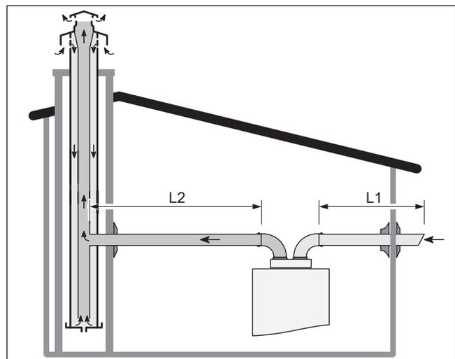
Los condensados que salen de los sistemas colectores no debe fluir hacia la caldera.
