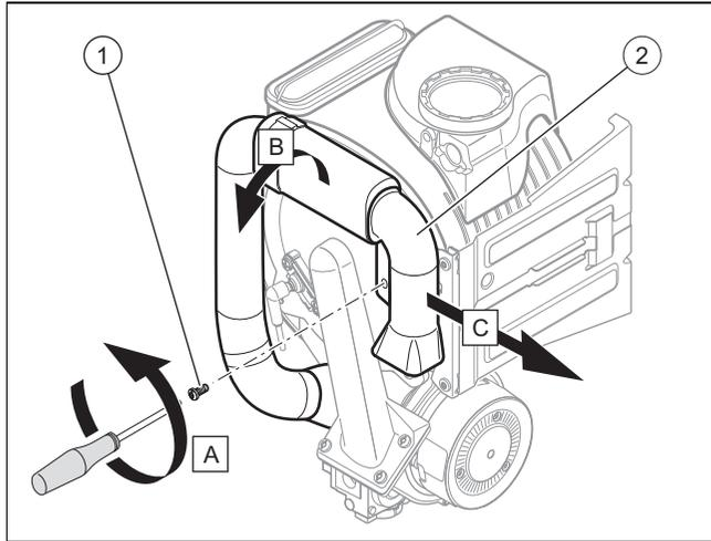
1. Retire el tornillo de sujeción del tubo de aspiración de aire (1) y el tubo (2).
