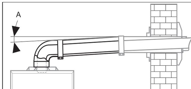
1. Compruebe que entre el codo y el accesorio del conducto de toma de aire/evacuación de gases de combustión haya una pendiente mínima (**A**) para que el condensado pueda volver al producto.
