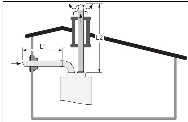
Coloque un aislamiento térmico en cada conducto que atraviese una pared y cuya temperatura supere la temperatura ambiente en 60 °C. Para el aislamiento térmico puede utilizar un material aislante adecuado con un grosor  $\geq 10$  mm y una conductividad térmica  $\lambda \leq 0,04$  W/mK (p. ej. lana de vidrio). Las piezas finales del conducto de aire fresco y de la tubería de evacuación de gases de combustión no deben instalarse en paredes opuestas del edificio.
