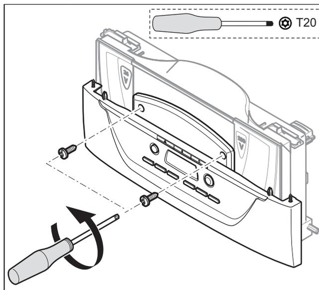
1. Retire los tornillos de sujeción y luego el revestimiento frontal.
