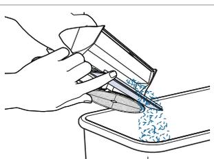
**5.** El recogedor de residuos se encuentra en la parte posterior del depósito. Tira hacia abajo la tapa y ladea el depósito para vaciar los residuos.
