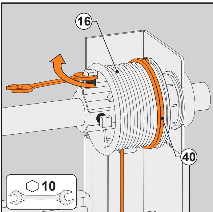
5.4 - Asegure el eje con un alicate de apretón, asegurándose que el cable está tenso (sobre tensión)
