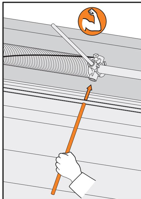
**6.1.4.** Libere la tensión del muelle de la 1ª herramienta de tensado con la 2ª herramienta.
