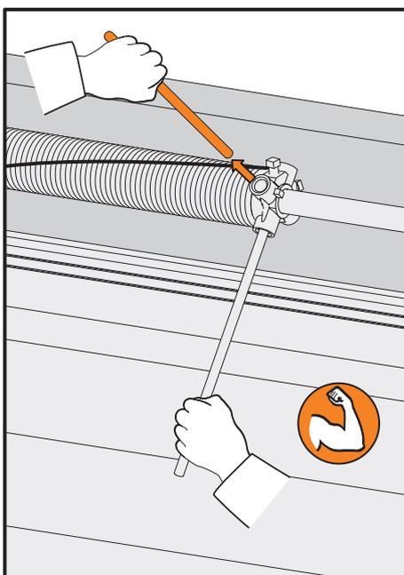
**6.1.6.** Gire la 2ª herramienta de tensado  $\frac{1}{4}$  de vuelta, de modo que el muelle que sometido a tensión.
