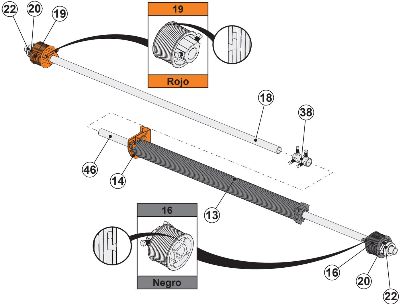
3.1.3 Apretar los 4 tornillos de la unión del eje (38).
