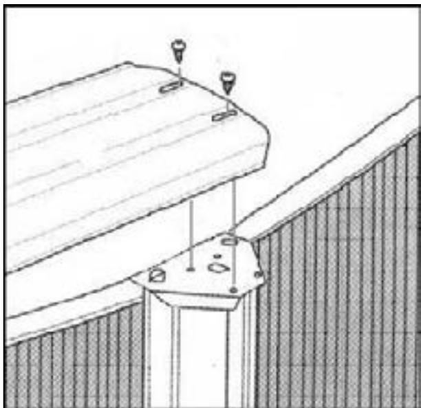
Repetir este proceso con el resto de los perfiles hasta cerrar el círculo. Al estar los tornillos sueltos, puede mover los perfiles a derecha e izquierda como ayuda para atornillar el último perfil. Dependiendo de la medida de la piscina, los perfiles pueden quedar un poco solapados.
