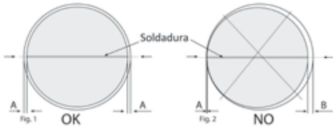
Es importante, que el liner quede bien centrado, extendido y con los mínimos pliegues en la base. Para quitar el exceso de pliegues en el suelo de la piscina, quítese los zapatos y extienda el liner hacia los laterales con los pies y manos, desde la soldadura central (S) hacia los lados, mientras llena de agua la piscina unos 2 cm. Tómese su tiempo, este paso bien hecho hará que el liner se quede sin arrugas.
