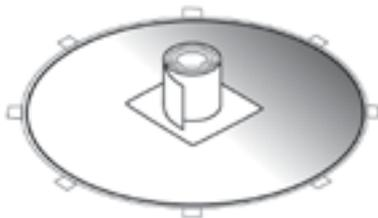
Ir colocando el extremo inferior de la pared dentro de las guías azules (PCA) siguiendo toda la circunferencia.
