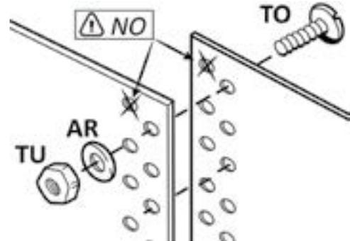
**IMPORTANTE:** Debe de colocar todos los tornillos de abajo hacia arriba. Apretar fuerte, todos los tornillos, utilizando un destornillador y una llave fija de la medida de la tuerca. **NO COLOCAR O NO APRETAR CORRECTAMENTE TODOS LOS TORNILLOS ANULA LA GARANTÍA.**
