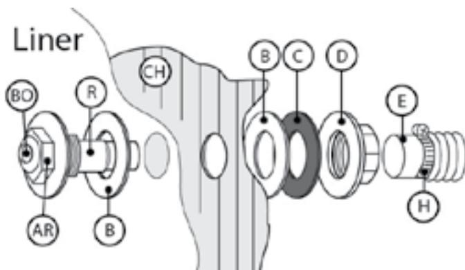
Para un mejor filtrado y un buen movimiento del agua, le aconsejamos que oriente el chorro del agua hacia abajo y un lateral de la piscina, para lo cual tendrá que aflojar la abrazadera AR y mover la bola orientable BO hacia uno de los lados de la piscina.
