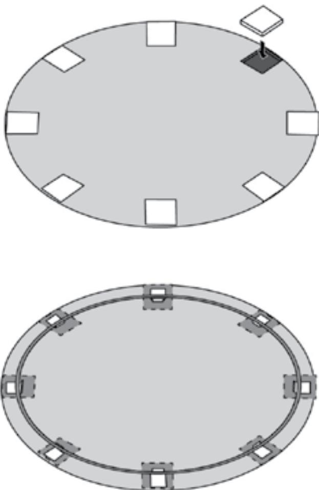
Las baldosas tienen que estar **a nivel del suelo**. Utilizar un nivel y una madera recta para asegurarse que las baldosas estén todas niveladas entre ellas.
