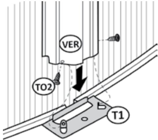
Las pestañas de la placa T1 deben quedar por dentro de la columna. Introduzca dos tornillos TO2 a ambos lados de la base de la columna.
