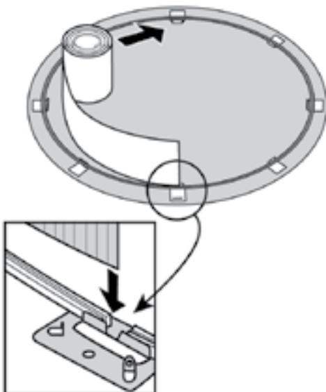
Junte los dos extremos de la pared metálica de manera que puedan pasar los tornillos (TO). La arandela (AR) y la tuerca (TU) deben de quedar en la parte exterior de la piscina. El ultimo agujero de arriba no se atornilla. Para los modelos de 120 cm de altura sobran 3 tornillos, 3 tuercas y 3 arandelas.
