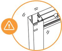
Prestar especial atención al anclaje entre pilares y guías, al no estar fijado totalmente podría soltarse y causar un accidente.
