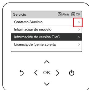
En cada pantalla del menú, como en la caja de la imagen de la izquierda, si sólo se despliega el icono “>”, usted puede ir hasta la pantalla de ajustes de detalles presionando el botón [>(derecho) o OK].
