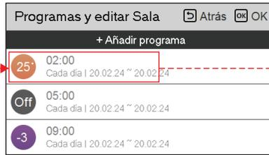
Puede revisar la información de la función del ajuste del temporizador (función de Encendido / Apagado, modo de funcionamiento, temperatura deseada), hora, periodo y día de la semana.
