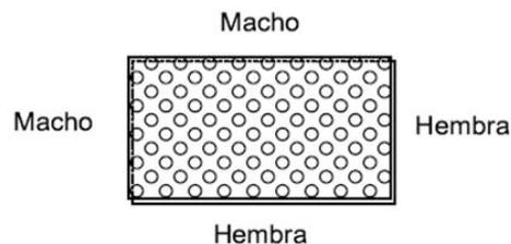
Los "tetones" moldeados que incorpora el panel permiten la instalación y fijación del tubo a un paso regular (múltiplos de 75 mm) de acuerdo con las necesidades térmicas. Los rebajes laterales de los "tetones" evitan que los tubos se separen del aislamiento, quedando el tubo totalmente paralelo con el forjado.
