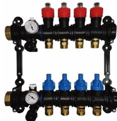
Los módulos termostáticos (bonete de color azul) están preparados para un control a distancia mediante cabezales electrotérmicos. Los módulos con caudalímetro (bonete de color rojo) permiten una regulación precisa del caudal de agua necesario en cada circuito. El modelo con caudalímetro incorpora módulos de regulación de 0 a 5 lts/min). Todos los módulos son auto estancos e intercambiables mediante un sistema de "clips" de sujeción rápida.
