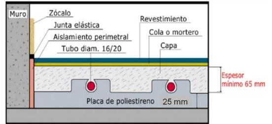
Una inercia térmica en exceso puede representar problemas a la hora de regular la temperatura del fluido caloportador, así como la regulación del confort ambiente. Por esta razón, se recomienda mantener un espesor máximo de 45 mm de mortero por encima del tubo.
