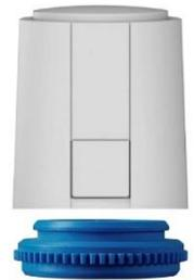
La válvula del colector que incorpora el actuador tiene una actuación lenta, con un tiempo de accionamiento entre la posición de abierto y cerrado de aproximadamente 3 minutos. La ventaja de utilizar válvulas de apertura y cierre lento permite un mejor funcionamiento del sistema de regulación, al estar la válvula en una apertura intermedia la mayor parte del tiempo.
