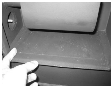
Limpieza de la cesta del quemador
