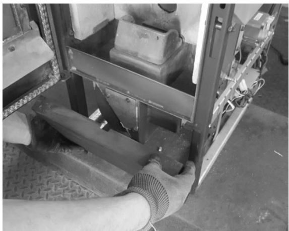
Retirada de la rejilla inferior
