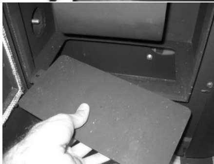
Limpieza del interior de la estufa
