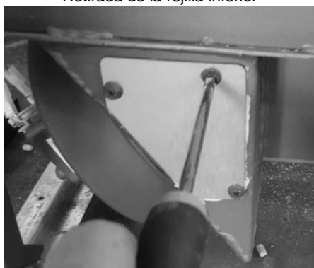
Retirada de la tapa frontal
