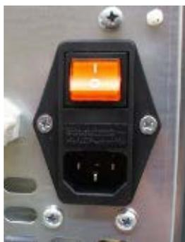
Fig. 42 - Toma de corriente con interruptor general
