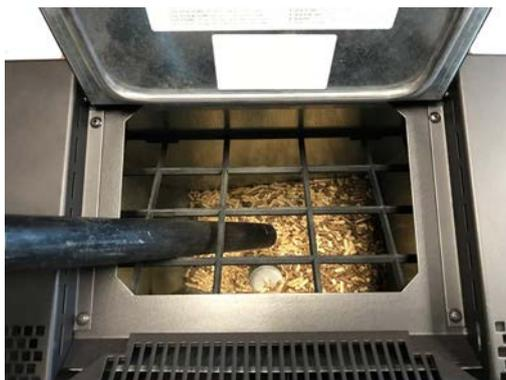
Fig. 74 - Limpieza depósito y coclea
