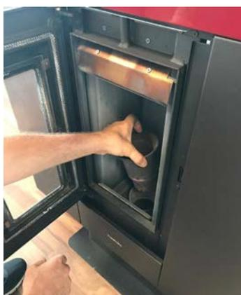
Fig. 69 - Extracción del brasero
