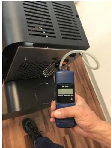
Fig. 48 - Conexión del presostato digital
