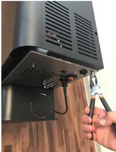
Fig. 47 - Extracción del cárter
