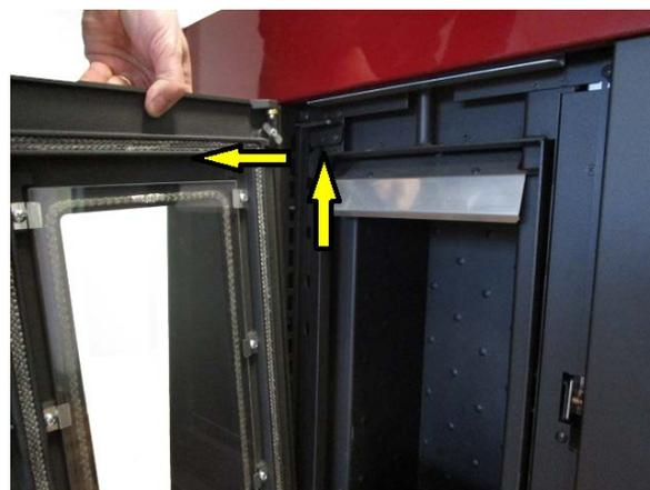
Fig. 28 - Desmontaje de la puerta
