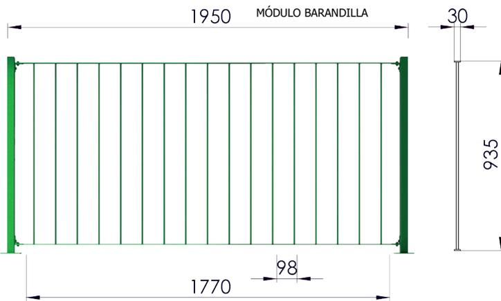
Los módulos de 1950x935mm están fabricados con plantillas inferior y superior de 30x6mm y barrotes macizos según modelo. Todos los diseños de barandilla modular cumplen con la normativa vigente y están diseñados pensando tanto en la seguridad del usuario como en su fácil instalación.
