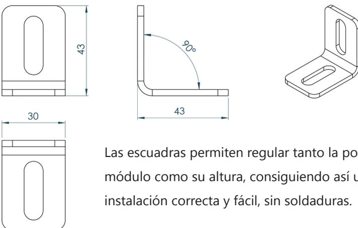
Las escuadras permiten regular tanto la posición del módulo como su altura, consiguiendo así una instalación correcta y fácil, sin soldaduras.
