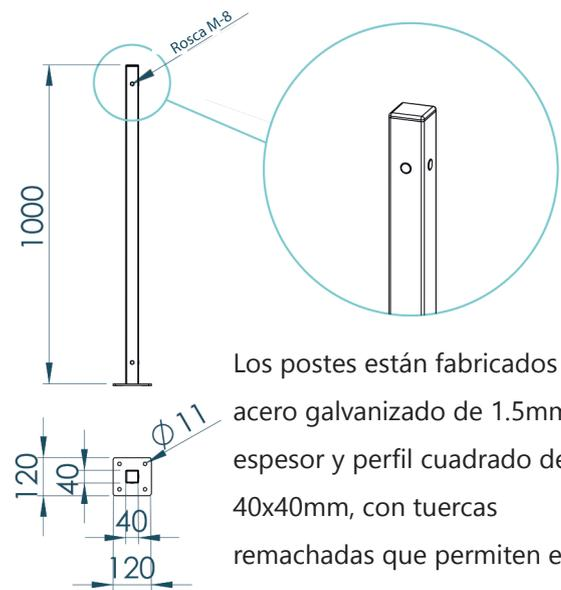
Los postes están fabricados en acero galvanizado de 1.5mm de espesor y perfil cuadrado de 40x40mm, con tuercas remachadas que permiten el atornillado de los módulos a la altura correcta. En cambio, para los postes para obrar, están disponibles sin la base inferior y 200mm más largos para el encastrado.
