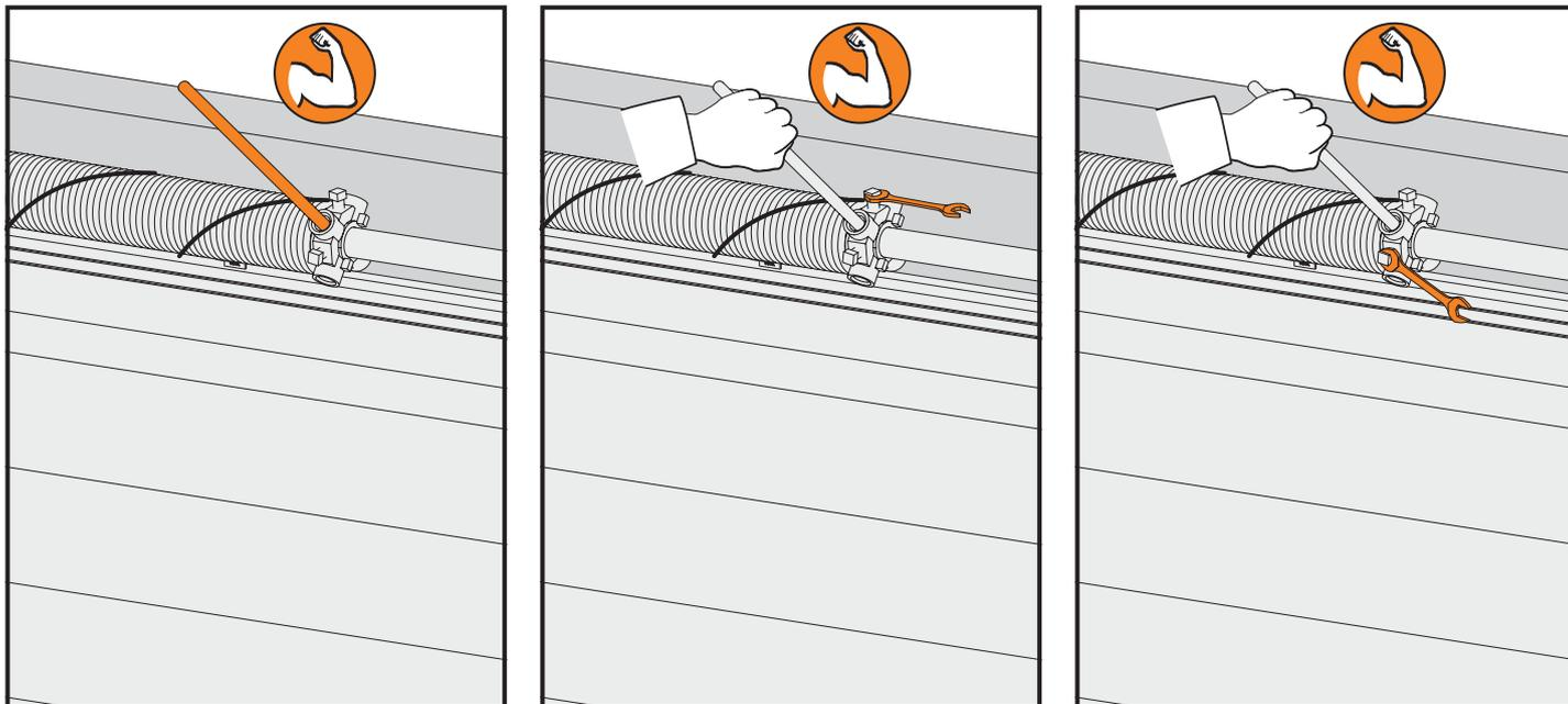
6.1.9. Retirar la barra de tensión del orificio.
