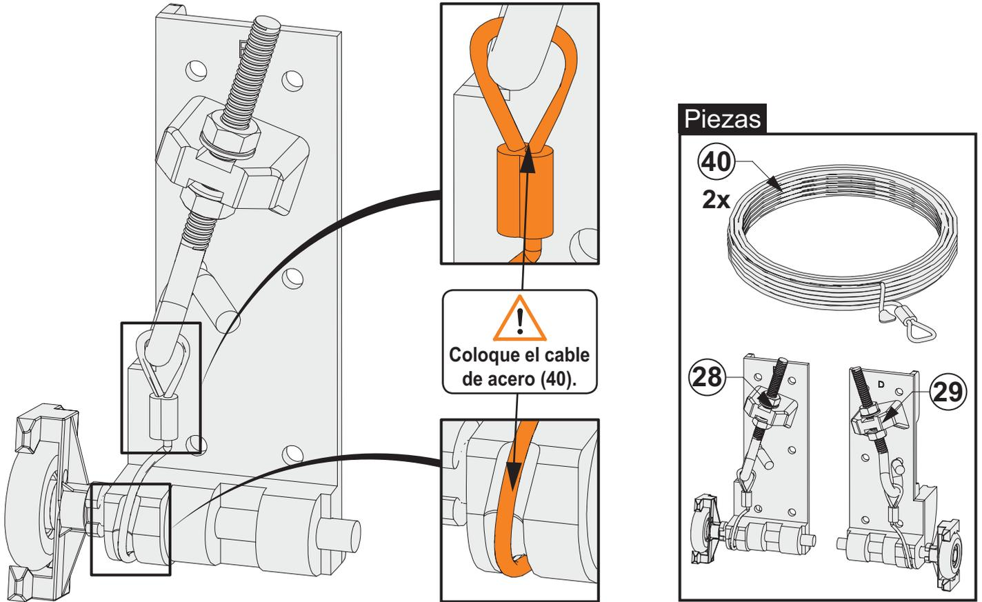
4.1.4 Fijación del soporte del cable izquierdo (28).
