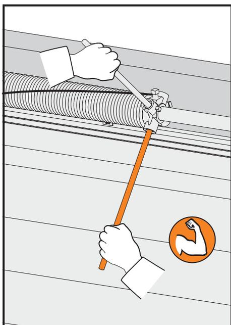
6.1.5. Extraiga la 1ª herramienta de tensado del orificio.
