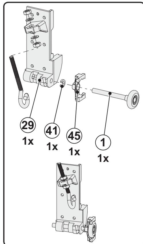
4.1.3 Inserte el cable (40) en el gancho ajustable del soporte de cable (28 y 29) y luego pase el cable en la ranura.
