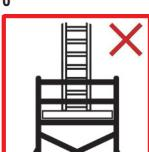
N'installez pas d'autres structures sur l'échafaudage pour augmenter la hauteur de travail.
