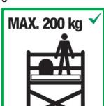
Charge maximale sur la surface totale du plancher : 200 kg.
