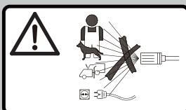
**ADVERTENCIA:** La hidrolimpiadora puede resultar peligrosa si no se utiliza correctamente. El chorro de agua no debe ser dirigido hacia las personas, los equipos eléctricos o la misma máquina.
