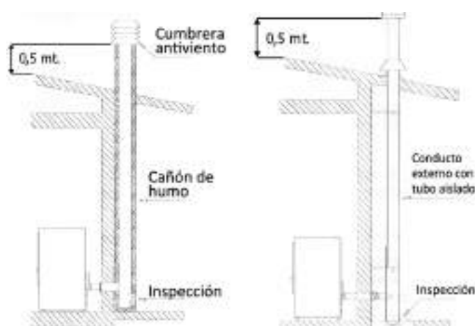
Fig. 2: conexión con el cañón de humo
