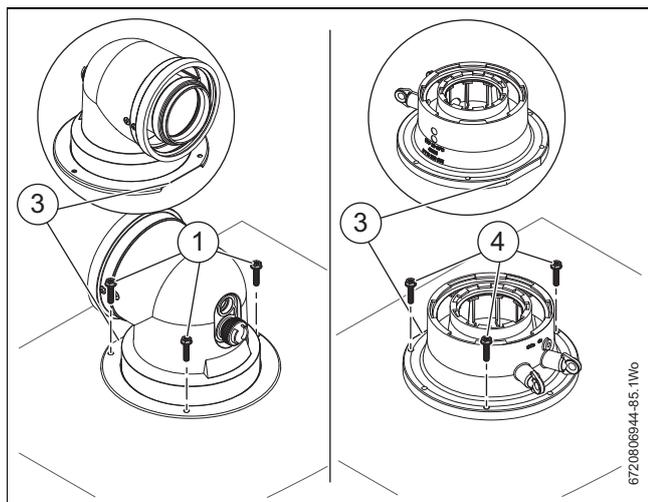
Fig. 37 Conexión del adaptador del conducto de evacuación
