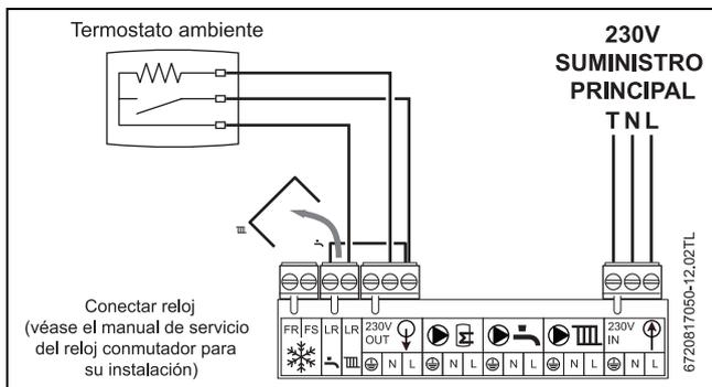
Fig. 48 Termostato ambiente con enchufe en reloj conmutador
