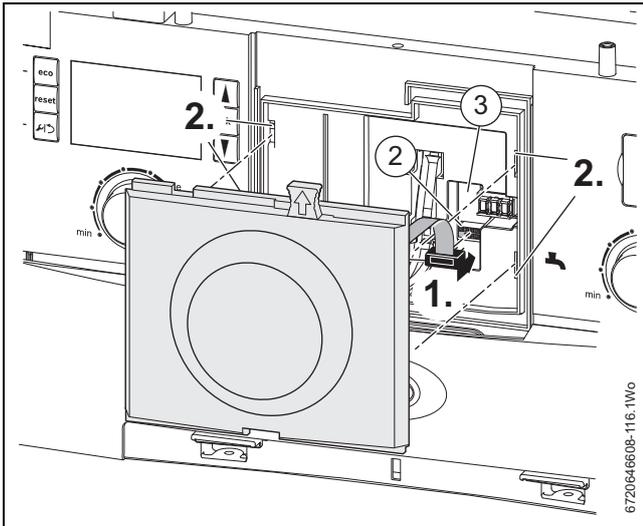
Fig. 43 Conectar el programador/reloj conmutador
