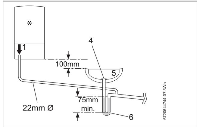
Fig. 8 Eliminación de condensado a un tubo de salida
