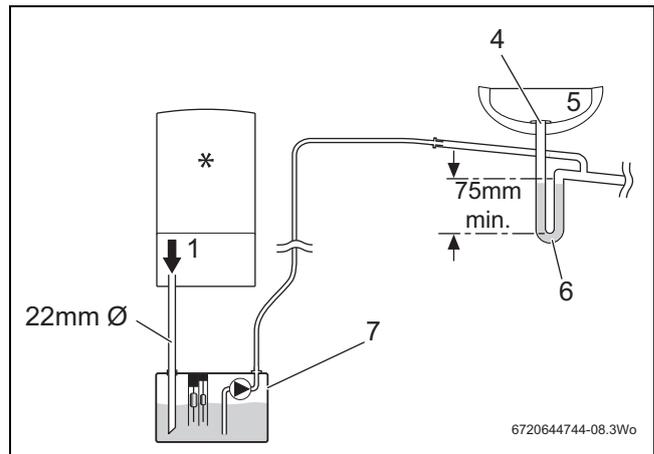
Fig. 9 Evacuación de condensados mediante bomba
