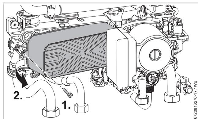
Fig. 71 Retirar el intercambiador de placas
