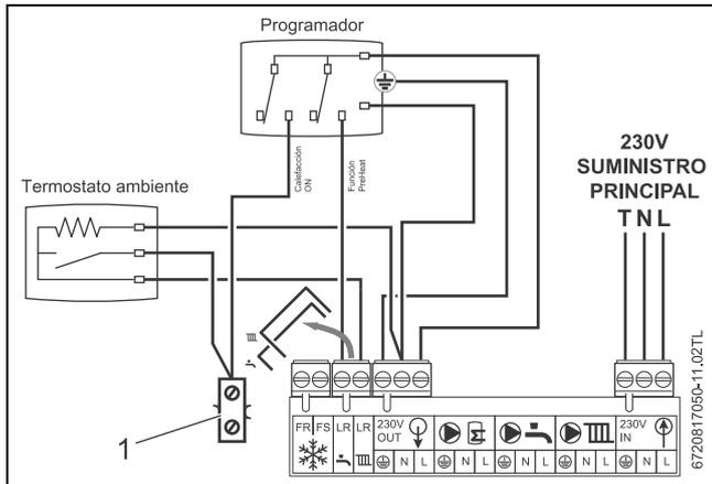
Fig. 47 Termostato del ambiente con programador
