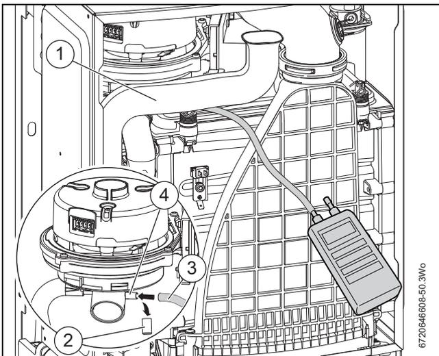
Fig. 64 Punto de medición de presión de ventilador
