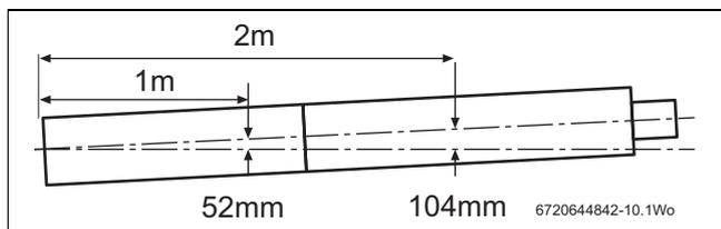
Fig. 38 Pendiente para eliminación de residuos de agua condensada
