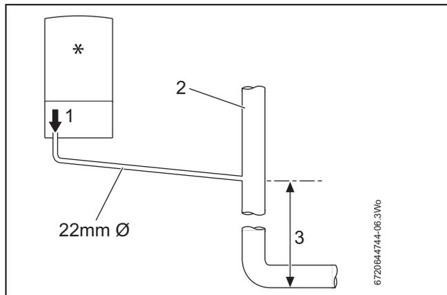
Fig. 7 Eliminación de condensado con orificio de ventilación
