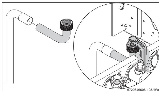
Fig. 28 Empalme acodado de válvula de seguridad
