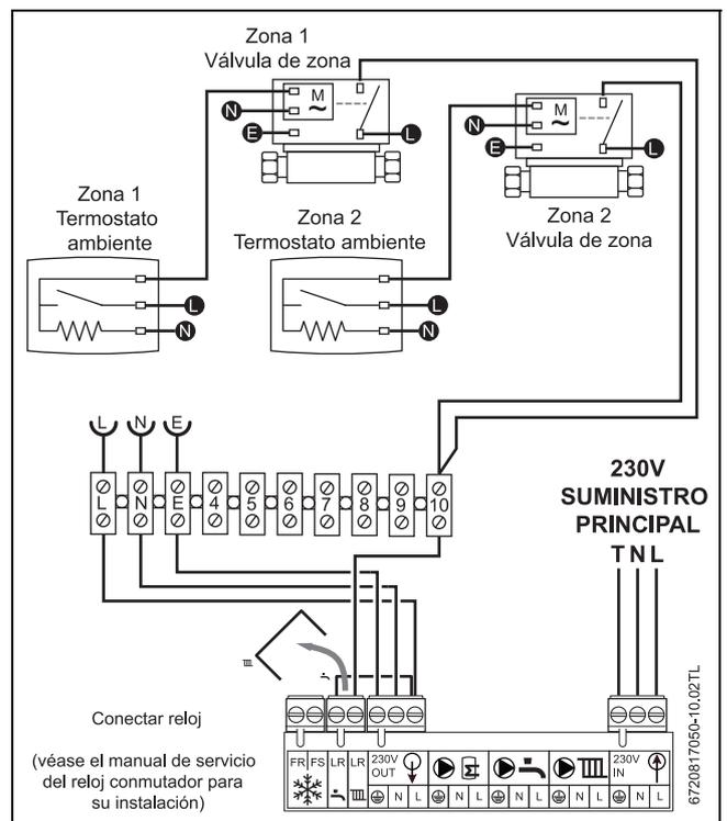
Fig. 46 Dos termostatos ambiente, un reloj conmutador integrado
