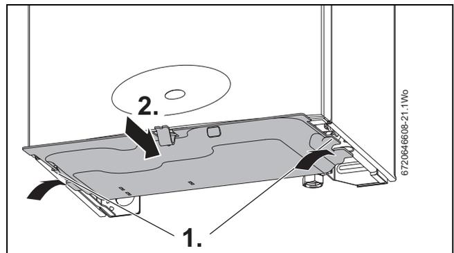
Fig. 60 Instalación del panel inferior
