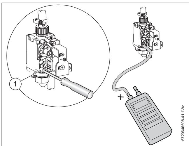
Fig. 53 Punto de medición de presión de entrada
