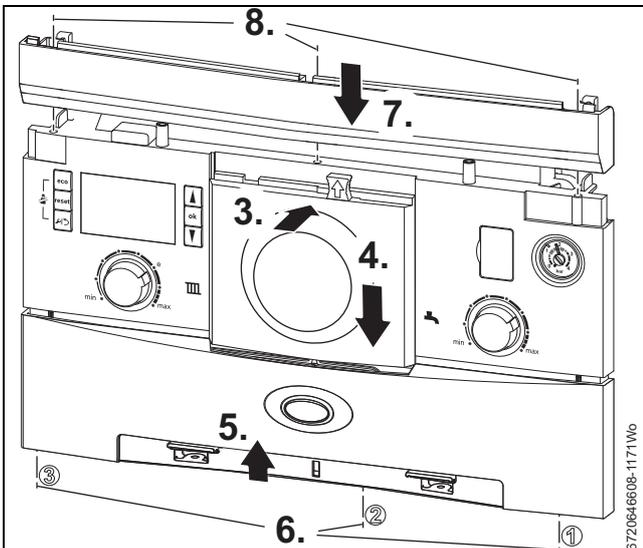
Fig. 44 Ajustar el programador/reloj conmutador
