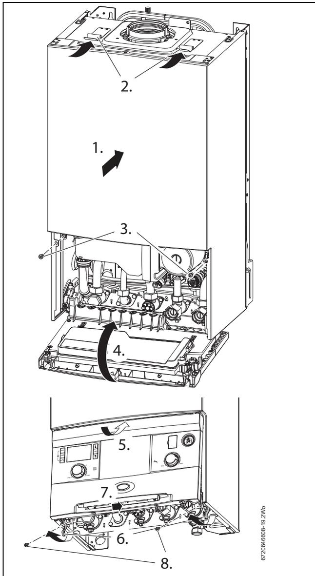
Fig. 58 Colocación de la carcasa y el cuadro de maniobra
