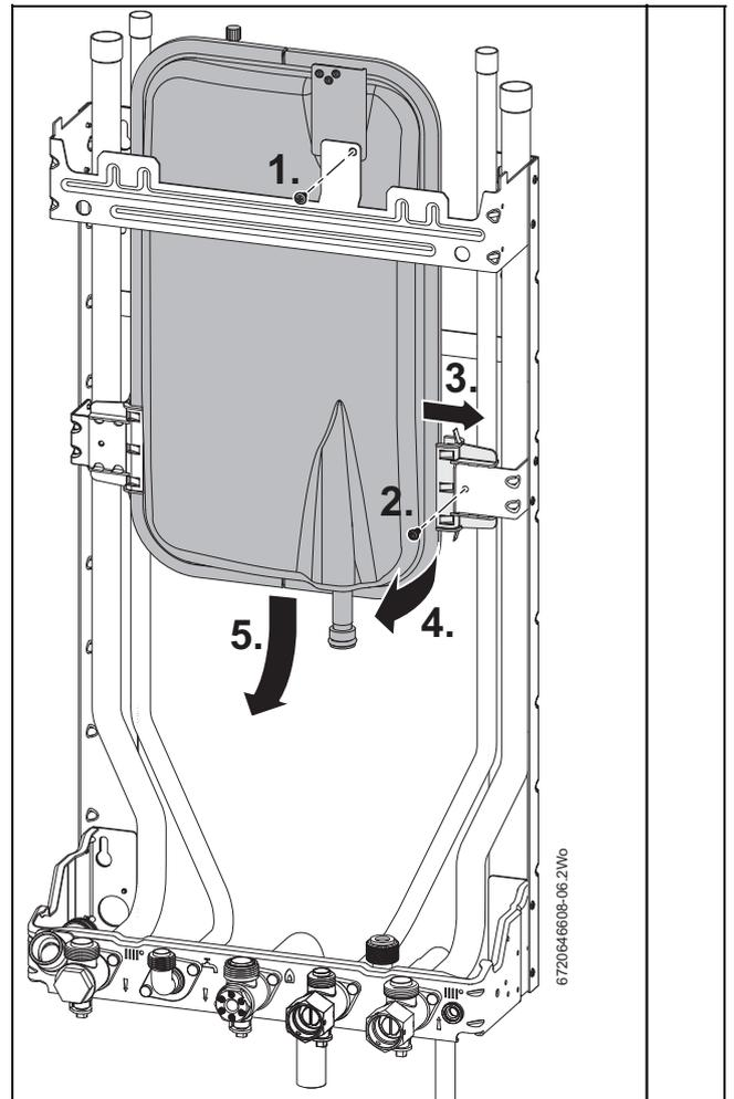
Fig. 75 Retirar el vaso de expansión
