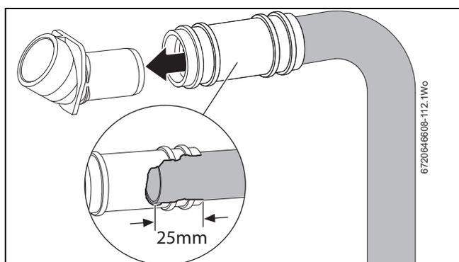
Fig. 26 Conexión del conducto de condensado
