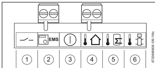
Fig. 40 Conectores de baja tensión
