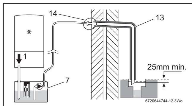
Fig. 12 Bomba de condensado a eliminación externa de condensado
