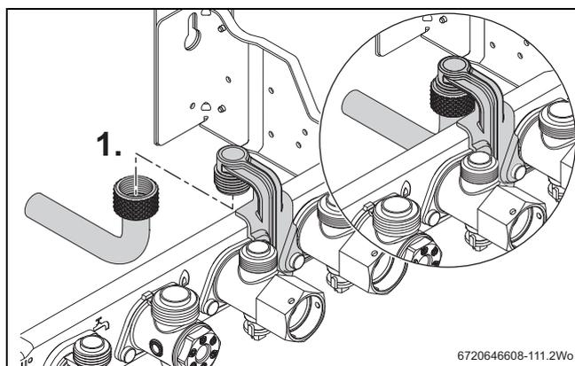
Fig. 27 Conexión de tubería de válvula de seguridad
