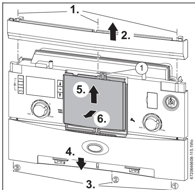
Fig. 42 Retirar la placa ciega
