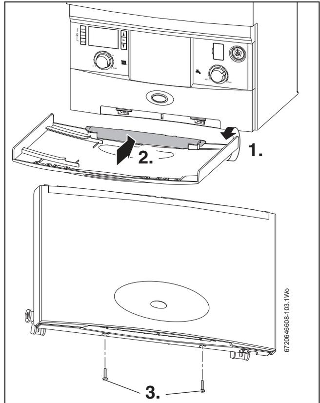
Fig. 59 Instalar la blenda del panel
