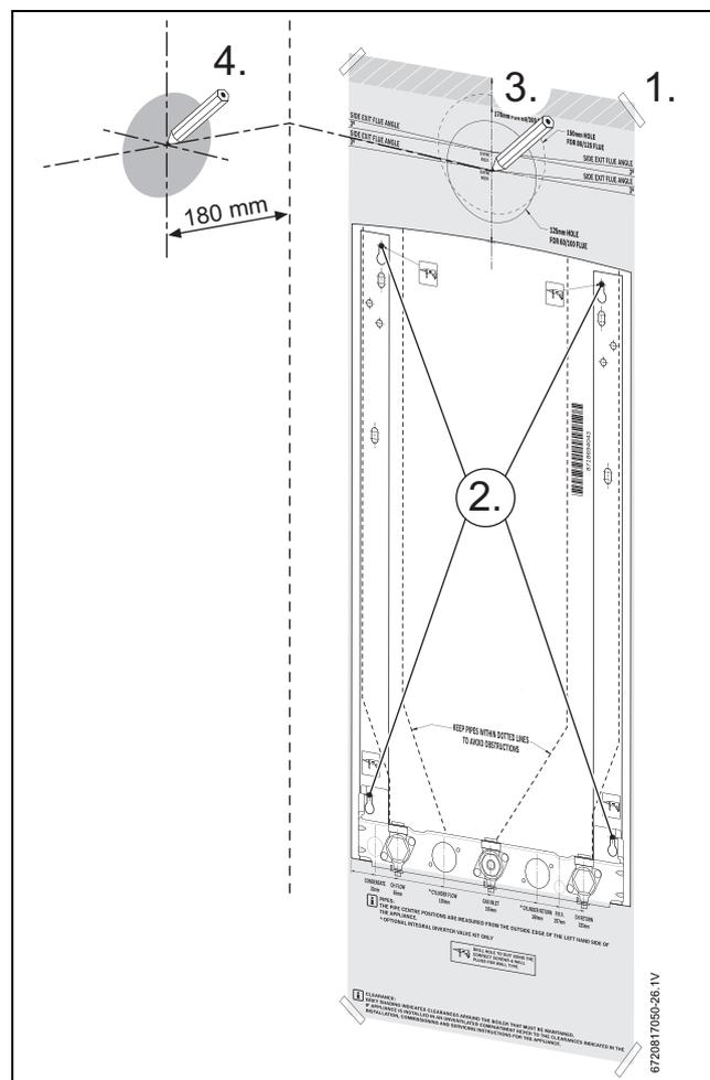
Fig. 21 Marcar la posición del conducto de evacuación
