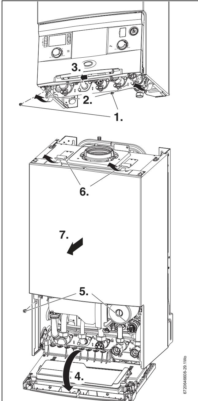
Fig. 62 Acceso a los componentes
