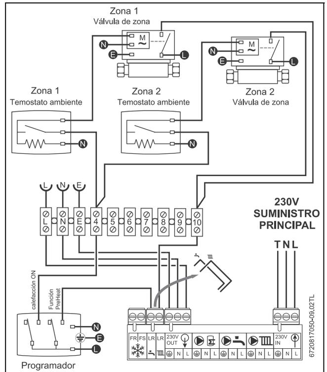
Fig. 45 Dos termostatos ambiente, un reloj conmutador externo
