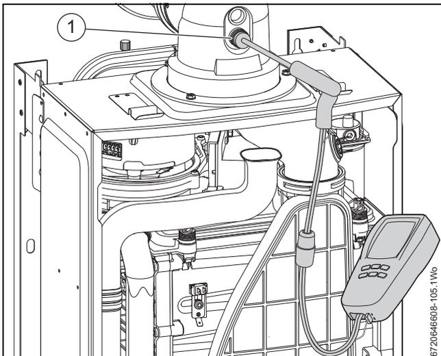
Fig. 66 Prueba de combustión
