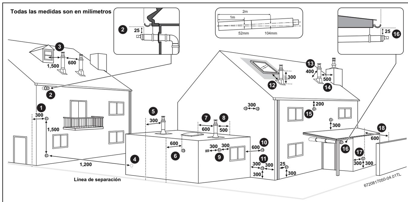
Fig. 19 Posiciones terminales del conducto de evacuación
