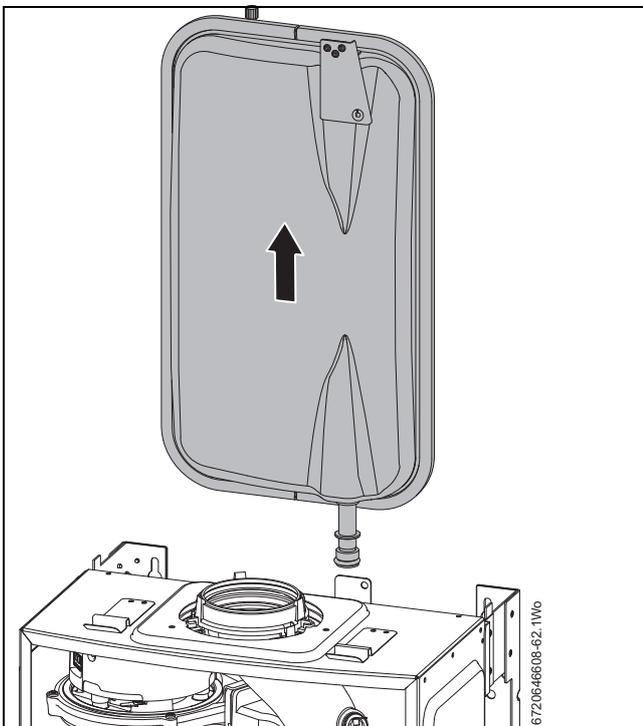
Fig. 74 Retirar el vaso de expansión
