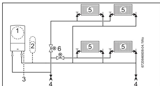
Fig. 6 Sistema cerrado con válvulas de zonas
