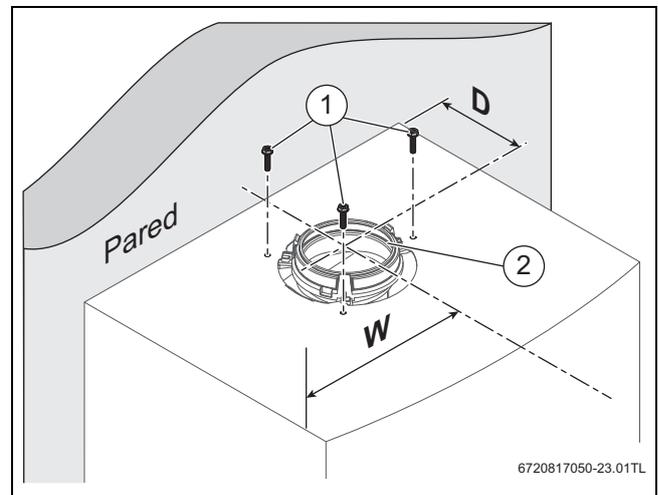
Fig. 36 Centro del adaptador de conducto de evacuación
