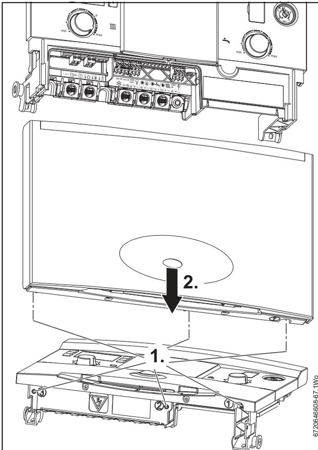
Fig. 72 Carcasa acceso del instalador
