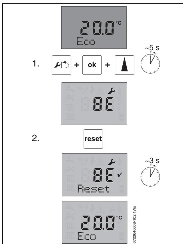
Fig. 79 Reseteo a los ajustes de fábrica
