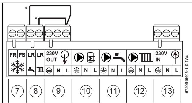
Fig. 41 Conectores de tensión de red
