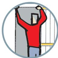
Colocar la lamina aislante sobre la cinta de doble cara
