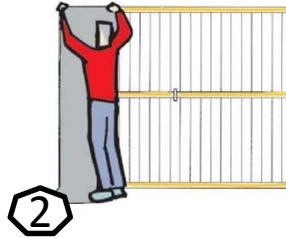
2 Coloque la lámina Polynum, sobre la cinta adhesiva.
