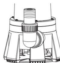
1. Limpie la turbina con agua a presión a través del prefiltro de la bomba.
