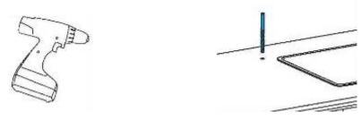
Introduzca la rosca del grifo junto al aro embellecedor cromado y la junta de estanqueidad por la parte superior de la encimera o pica de acero.
