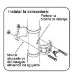
Conecte un tubo para el desagüe y el otro extremo al restrictor (DRAIN).
