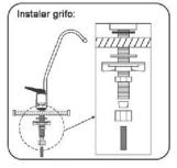
Introduzca un extremo de la tubería en la conexión cromada rosca hembra, coloque en el extremo del tubo el ovalillo blanco de plástico e introduzca la pieza recta blanca dentro del tubo. Una vez lo tenemos, enroscar a la rosca inferior del grifo, asegurando la estanqueidad. A continuación conecte el otro extremo al codo de salida del post filtro (FAUCET).
