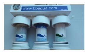
Lo mismo realizaremos con la membrana, para ello, hay que desenroscar la tapa del contenedor. Retirar la membrana de su embalaje (Bolsa) y colocarla dentro del contenedor. Asegurarnos que el extremo de las dos juntas vaya al final, y presionando
